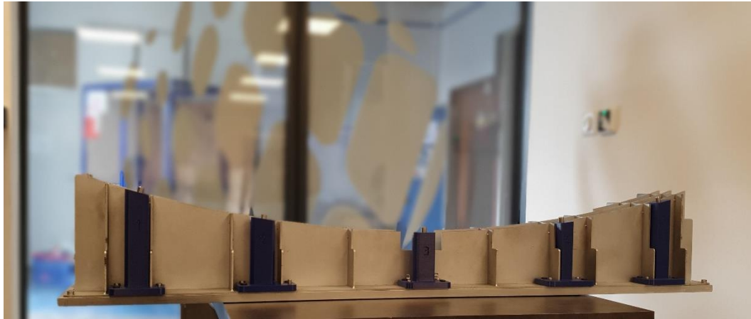
Maquette de contrôle d'un bord d'attaque pour A330-A340 produit par Fabrication Additive
